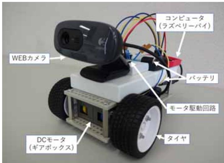
人の入り込めない危険な場所にロボットを投入して、作業させるといったケースを想定します。
