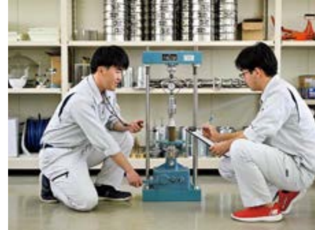
土の一軸圧縮試験 (材料試験)
