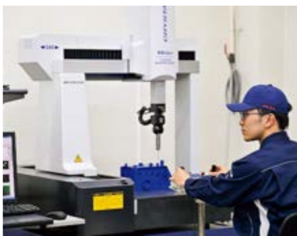
三次元測定機による立体モデル計測
