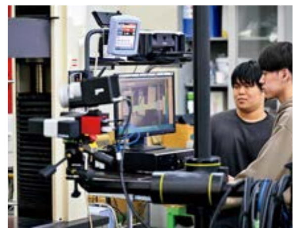
非接触ひずみ測定(デジタル画像相関法)
