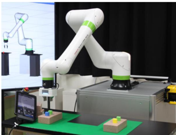
FANUC 社製 協働ロボットとその教示装置
